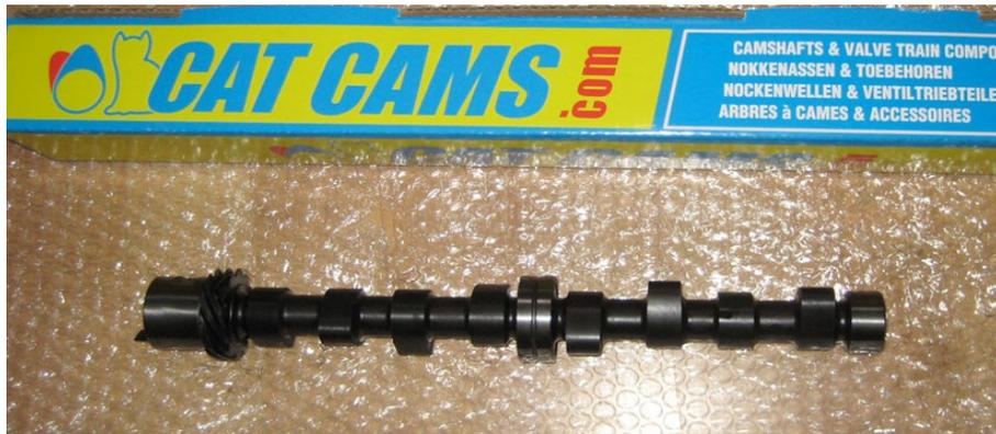
Ich hab mir eine neue Nockenwelle (287°) von Cat Cams geholt, da ich meinen Motor kompl. mit Neuteilen überarbeitet habe, da kam auch nur eine neue Nocke in Frage. Das heißt, ich hab die KW geglättet und gewuchtet, Schwungrad erleichtert auf 3,7kg und gewuchtet, Kolben und Pleul ausgewogen, da die Pleul Unterschiede von bis zu 12g haben, sollte man das auf jeden Fall machen! Den Zylinderkopf hab ich auch kompl. überarbeitet, Ein- und Auslass geglättet und angepasst.
