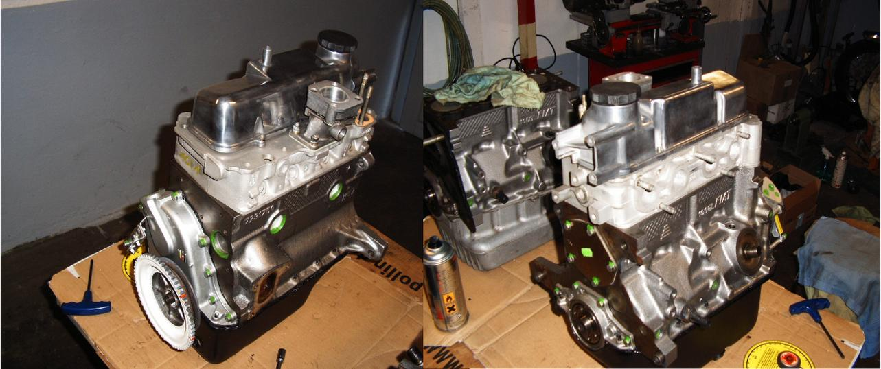
Auf den Bildern ist der Seat Kopf zu sehen, gut zu erkennen die 3 Befestigungsbohrungen für die Entlastungsstrebe. Vorne fehlt der Anschluss für den Heizkreislauf, der ist aber am Seat Thermostat, und braucht nur verlängert zu werden. Es kann aber auch aufgebohrt werden, zum Gewinde schneiden ist Material genug vorhanden.
