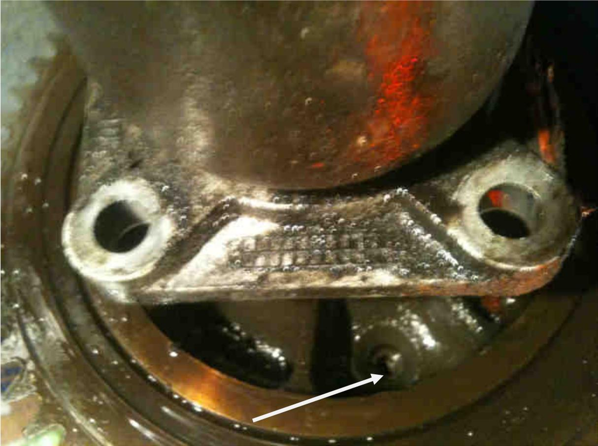
Dieser Stift muss dann mit einem Hilfswerkzeug.. einem Alten Bohrer ausgetrieben werden....
